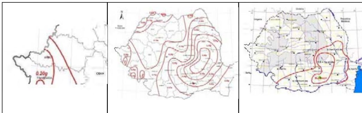
Figura nr. 6: Zonarea valorilor de vârf ale accelerației terenului pentru proiectare, a_g și Zonarea seismică după perioada de control a spectrului de răspuns T_C (sec)
