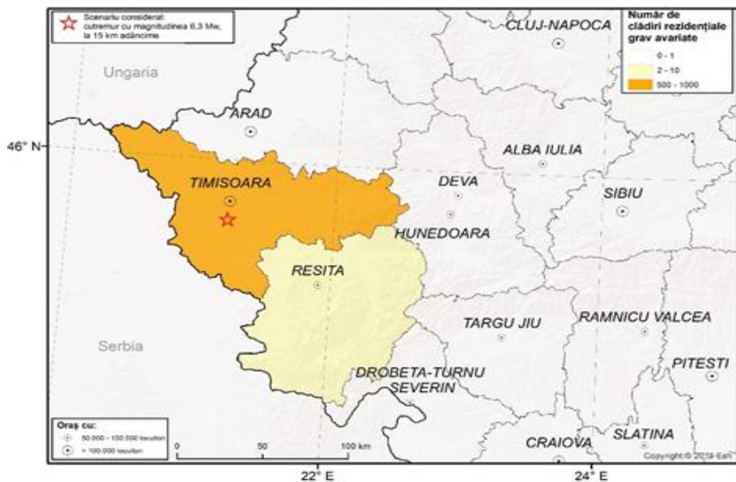
Figura nr. 8 Număr de clădiri rezidențiale grav avariate la nivel de UAT, ca urmare a unui cutremur reprezentat pe hartă, cu magnitudinea 6,3 Mw, la adâncimea de 15 km (cu epicentru în zona Banat)
